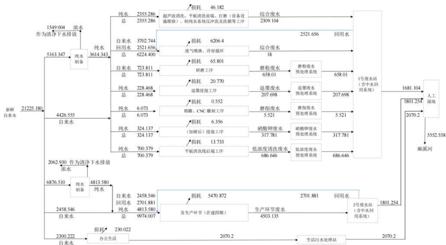
图 3.3-12 现有项目水平衡图 (t/d)
