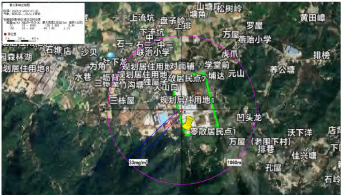
图 9.4-4 盐酸泄漏产生的 HCl 在下风向的最大影响区域
