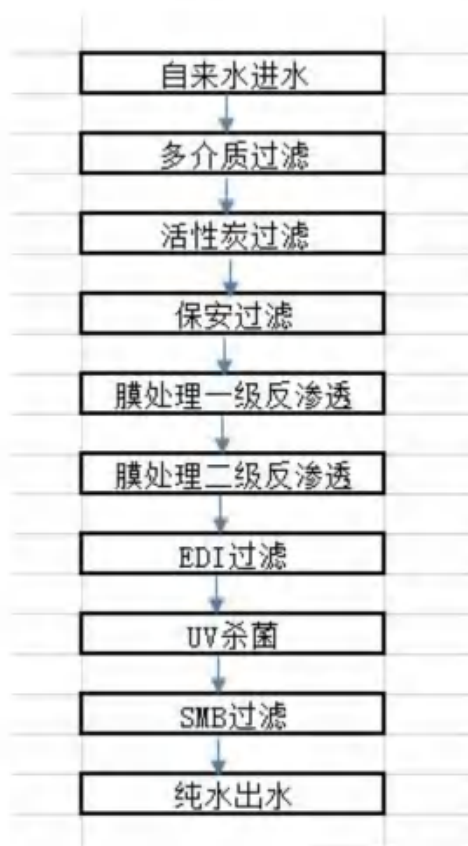
图3.3-11 纯水制备流程
