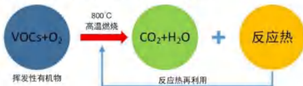
图8.2-2 旋转式 RTO 原理
